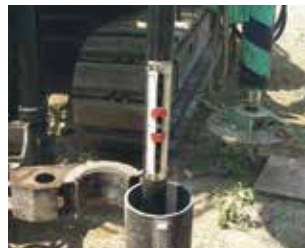
⊕α(2) スライドウェイト計測（支持地盤の確認）
